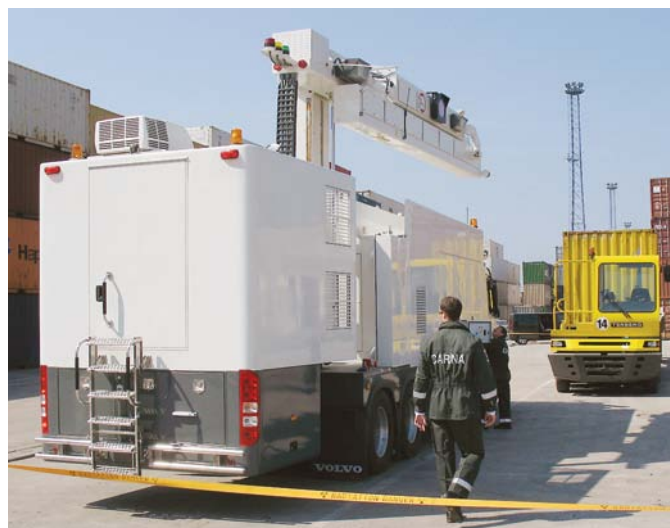
Rentgenska naprava za presvetlitev zabojnikov v koprskem pristanišču. Foto: Sabina Langus Boc.
